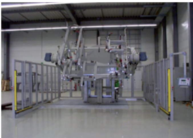
Schweißvorrichtung für die Automobilindustrie
